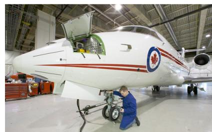
Un technicien en essais non destructifs certifié par RNCan procède à une inspection par ultrasons du train d'atterrissage d'un Challenger CC144, pour voir s'il y a des fissures autour des trous des boulons.
